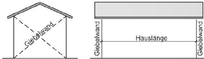
4. Das Maß der Hauslänge gilt als unterbrochen, wenn die Grundfläche des Baukörpers von einem Rechteck abweicht, das heißt, an mindestens einer Gebäudeseitenwand mit einem teilweisen Rücksprung von mindestens 1,00 m versetzt ist (unterbrochene Hauslängen).
